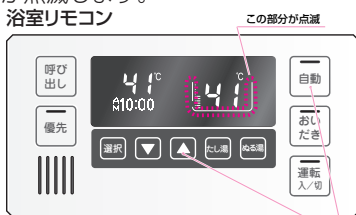
▲スイッチを1秒間以上押しながら自動スイッチを押す。 (運転スイッチ「入」、自動スイッチ「切」、通常表示状態で操作)
